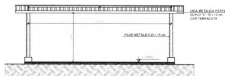
4 CORTE B - B ESCALA 1/50
