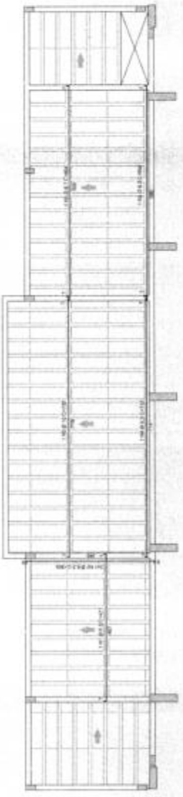
4 Armadura positiva lige cobertura vestiário (+2,93m) ESCALA 1:50
