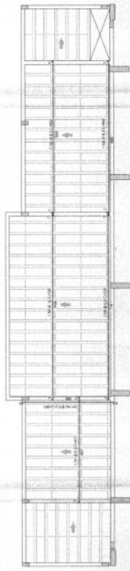
4 Armadura positiva da cobertura vestiário (+2.93m) ESCALA 1/50
